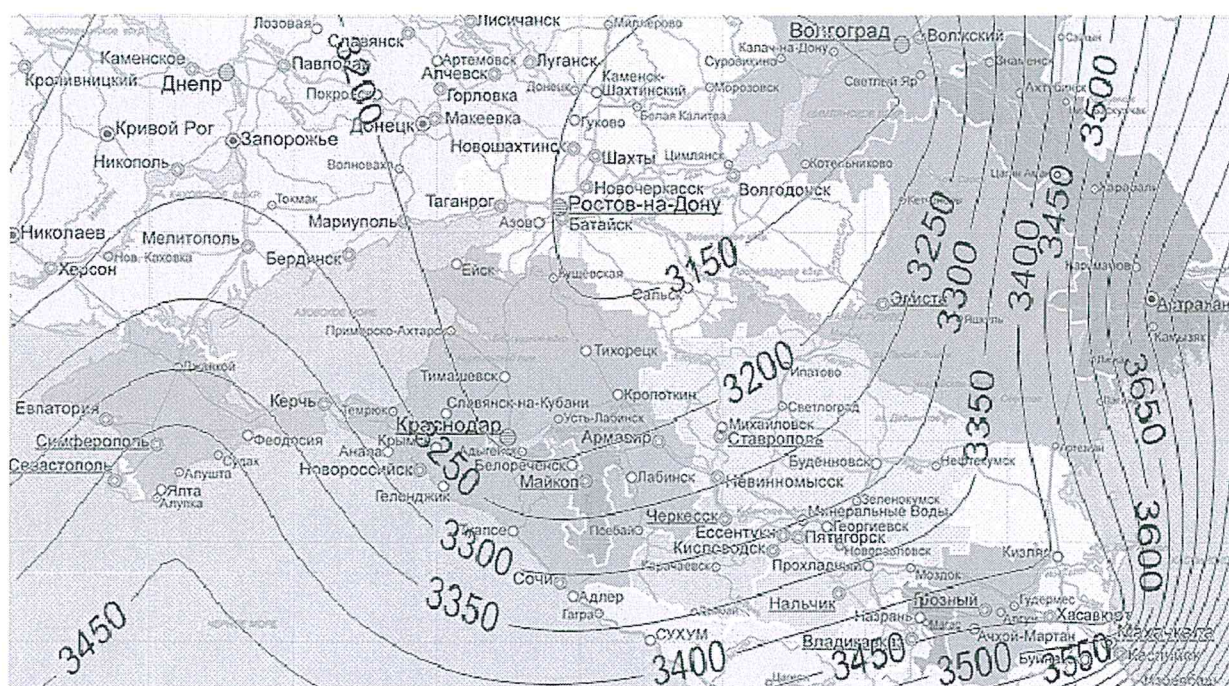
Рисунок 14 – Карта изолиний количества суммарной солнечной радиации на вертикальную поверхность при действительных условиях облачности на южный фасад за год, МДж/м 2
