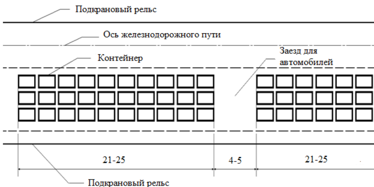
Рисунок 4 – Схема поперечного заезда автомобилей
