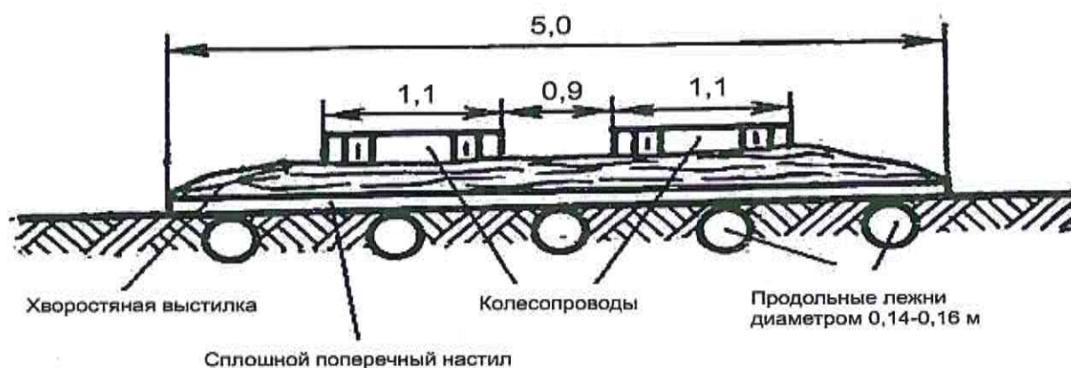
Рисунок 10.4 – Поперечный профиль лесных дорог из деревянных щитов на болотах типа II с толщиной торфа выше 2 м
