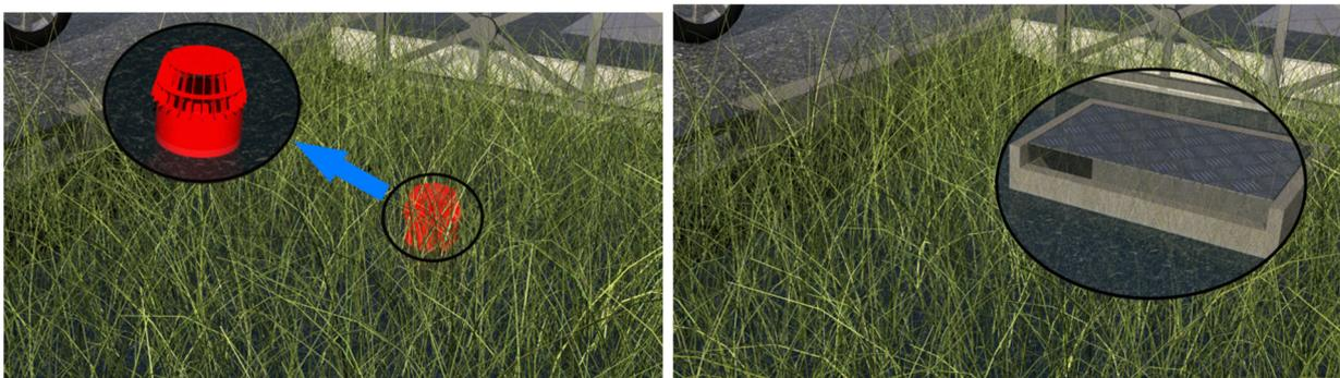
**Рисунок 6.45 – Пример устройств для отвода воды из дождевого сада**
