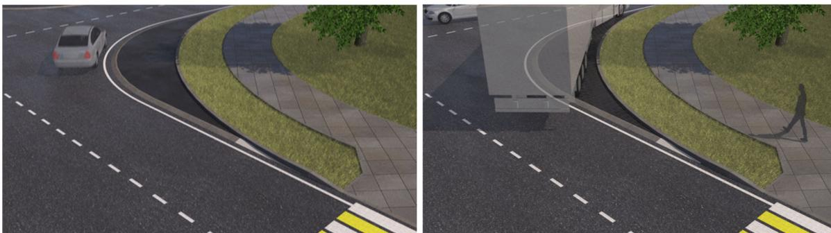
**Рисунок 5.7 – Пример устройства отмычки для пропуска грузовиков**
