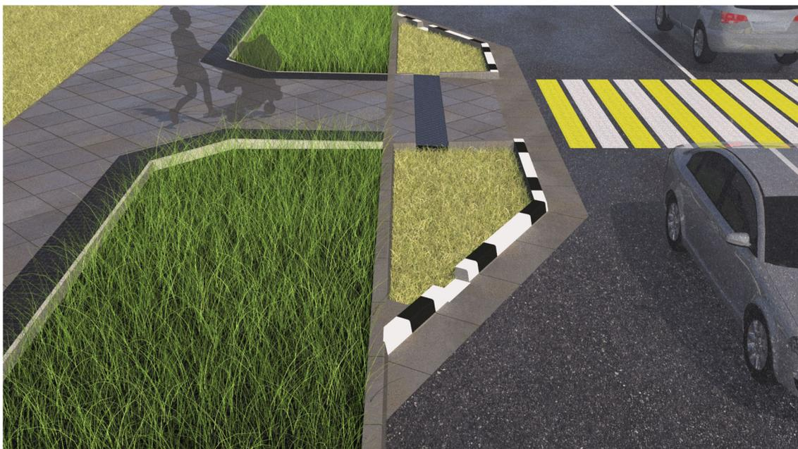
**Рисунок 6.51 – Расширение бордюра для размещения элемента водоотвода**
