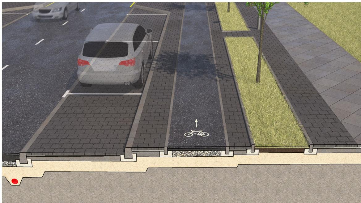
**Рисунок 6.13 – Схема расположения дренажных покрытий парковки и велосипедной дорожки**
