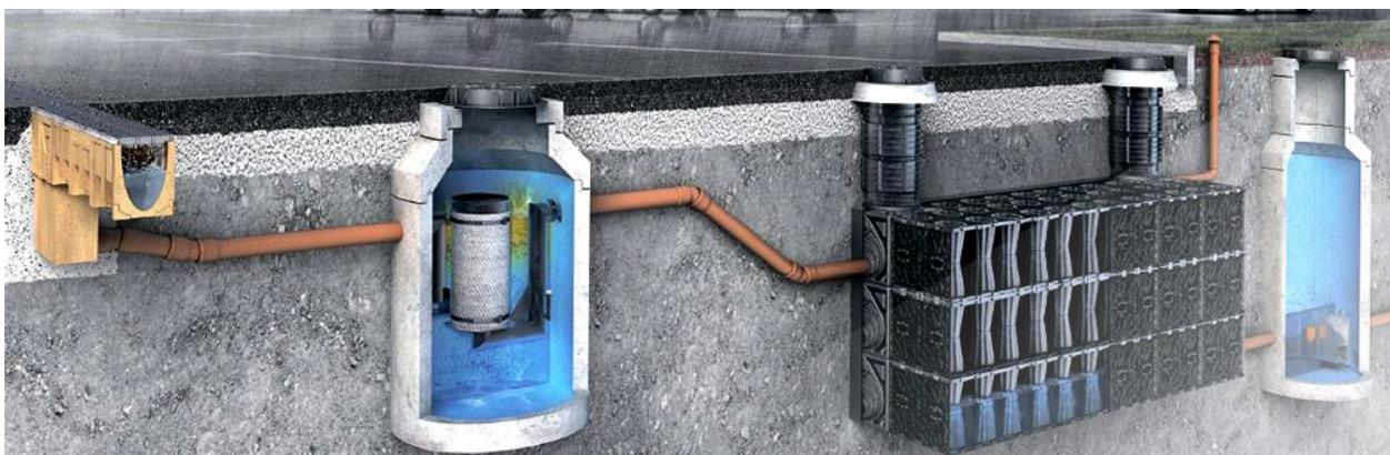
**Рисунок 6.34 – Технологическая схема инфильтрационной системы для приема дождевых вод с дорожной поверхности [34]**
