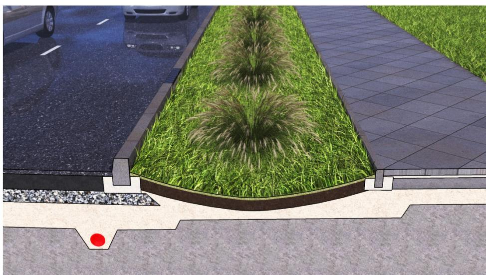
**Рисунок 6.39 – Схема расположения дренажных канав с засевом трав и мелких кустарников**
