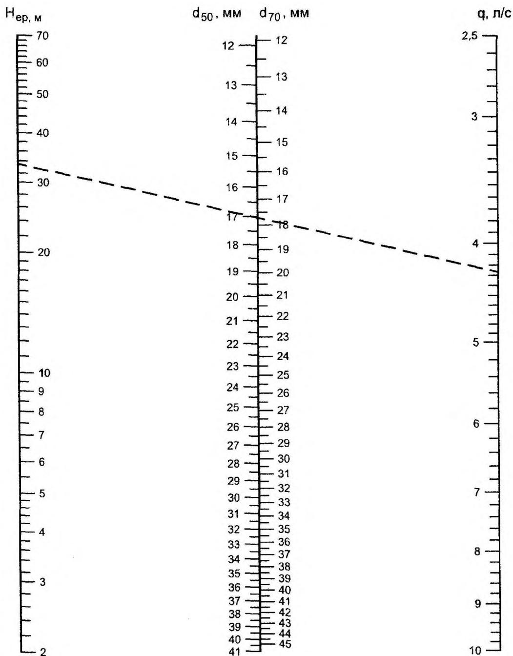
$d_{50}, d_{70}$  – диаметры отверстий диафрагм, устанавливаемых
