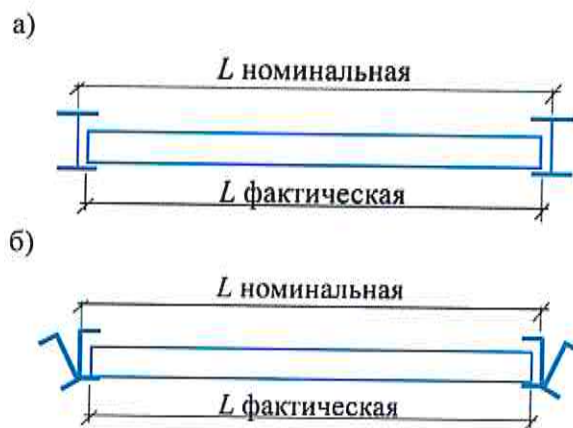
Рисунок 10.1 – Определение длин панелей при прямых (а) и поворотных (б) стойках
