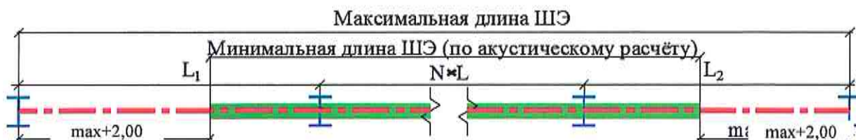
Рисунок 8.1 – Определение максимальной и минимальной длин шумозащитного экрана
