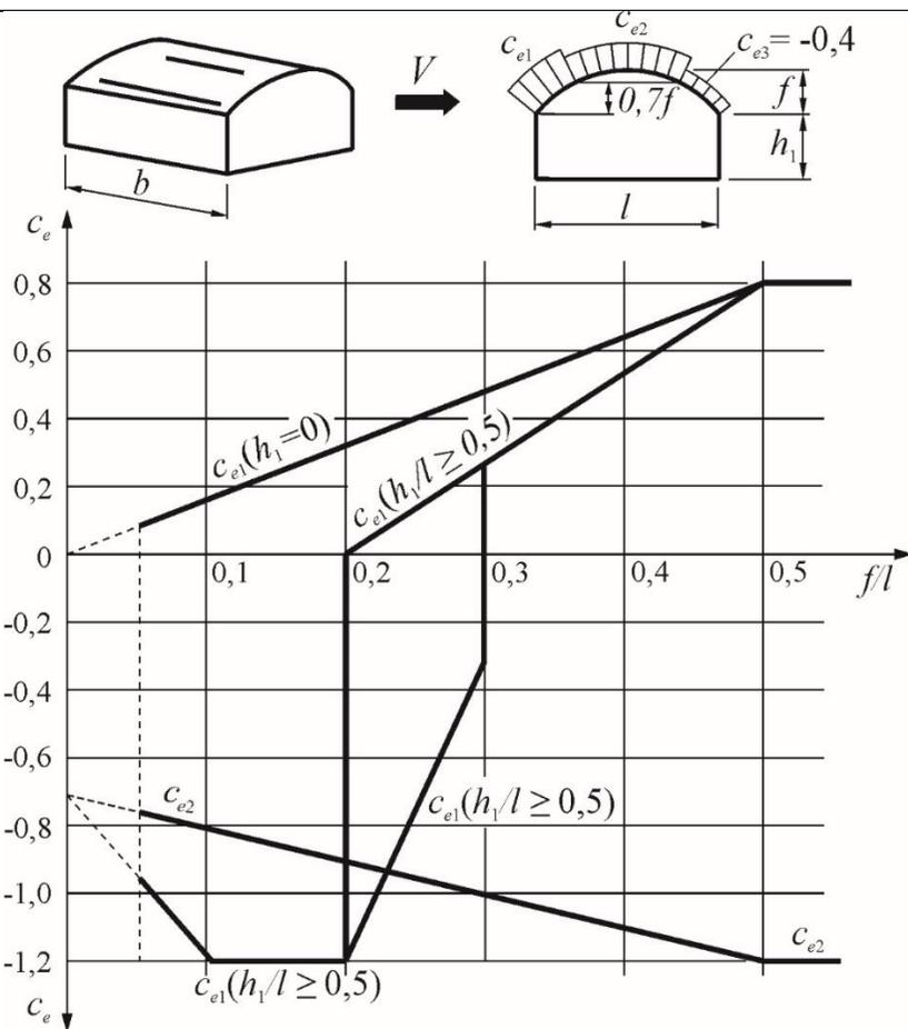
– При  $0,2 \leq f/l \leq 0,3$  и  $h_1/l \geq 0,5$  необходимо учитывать два значения коэффициента  $c_{e1}$ .
