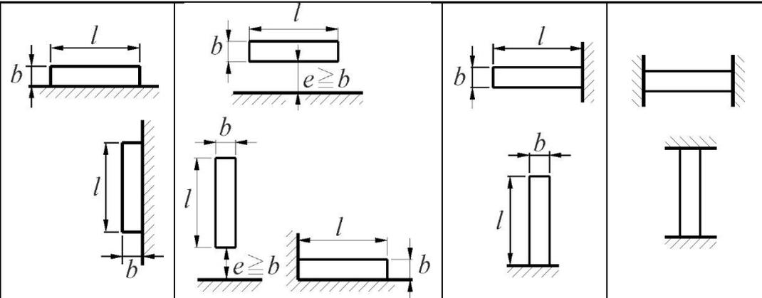
Примечание –  $l, b$  – соответственно максимальный и минимальный размеры сооружения или его элемента в плоскости, перпендикулярной направлению ветра.
