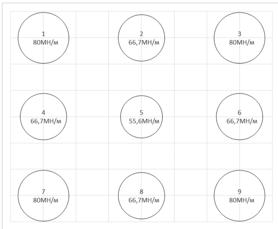
**Рисунок 24 – Схема коэффициентов жесткости свайного фундамента при абсолютно гибком ростверке**
